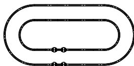
HMG15A 2 UU C1+1000LT+60/150R 6T+60/300R 6T-II 2 세트 주) HMG형을 발주할 때에는 LM블록, LM레일의 배치를 알 수 있는 참고도를 첨부해 주십시오.
