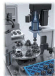
Application example : Press-Fit Machine 使用例: プレス機
